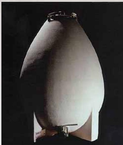
Les fameux oeufs !! Ces cuves cherchent à retrouver le principe des amphores ou des tonneaux, c'est à dire, la création de mouvements browniens dans le liquide, dit mouvement « vortex », afin de maintenir les lies constamment en suspension, lies qui seraient petit à petit « consommées » par le vin, et lui apporteraient rondeur, fruité et souplesse... Mais aucun résultat scientifique n'a jamais été publié...
