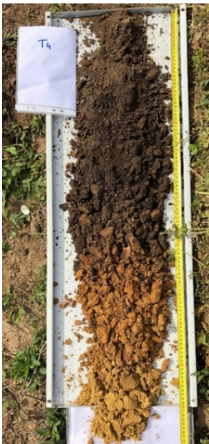
Fig 2. Sondage à la tarière
