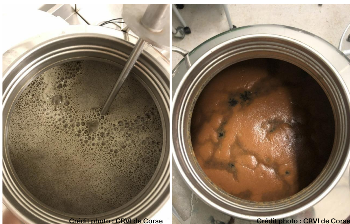
Figure 11 : Cuve de moût au cours de l'injection d'O 2 (à gauche) et 12h après injection d'O 2 (à droite)
